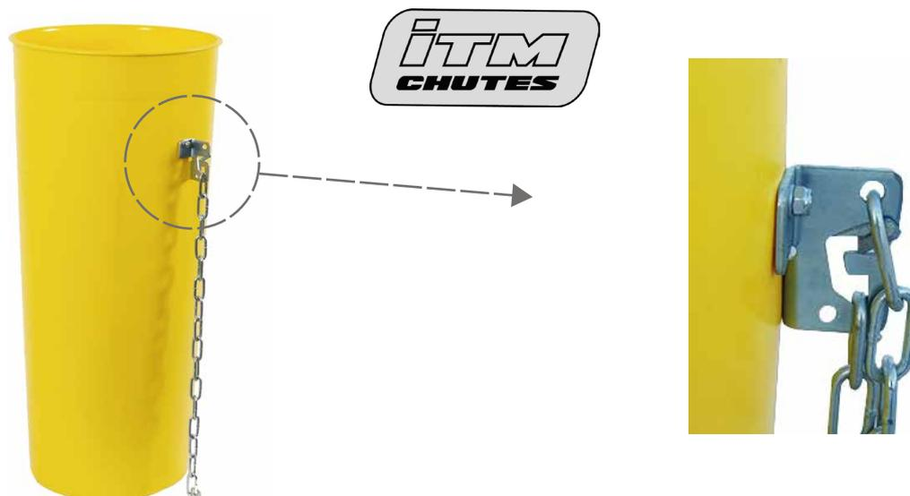
Los **tubos de escombros estándar** son una solución eficiente para la correcta evacuación de escombros en cualquier obra. Evitan la fuga de cascotes y disminuyen el efecto del ruido y el polvo. Su uso es muy sencillo. Se coloca una sucesión de tubos, formando una columna, desde el punto de evacuación hasta el contenedor.
